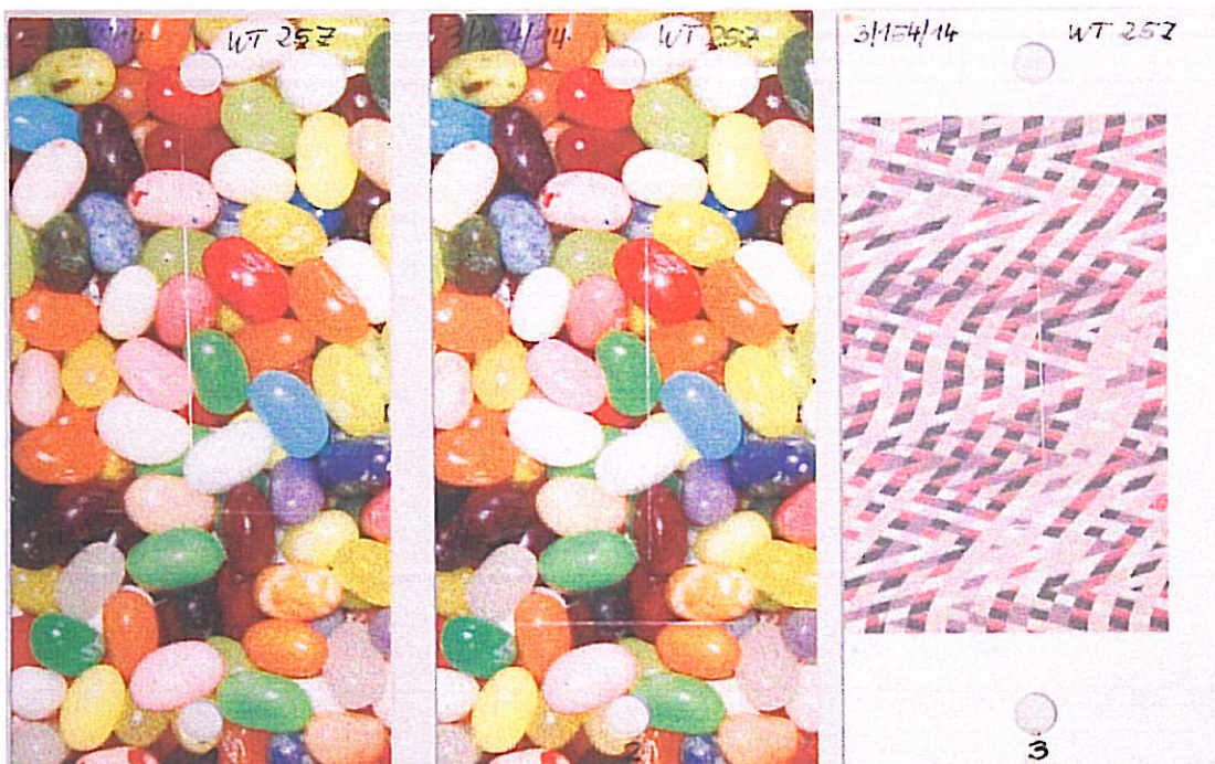
Abb. 1: Proben nach 25 Zyklen Wechseltest ISO 20340
